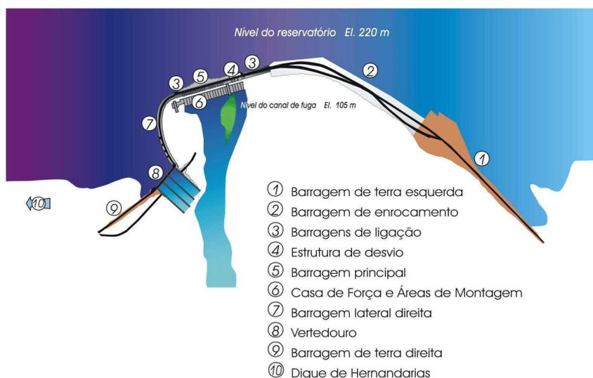
Figura 1: Planta da Barragem.
